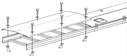
カバー止め金具用ボルトは確実に締め付けてください。飛散・落下の恐れがあります。
