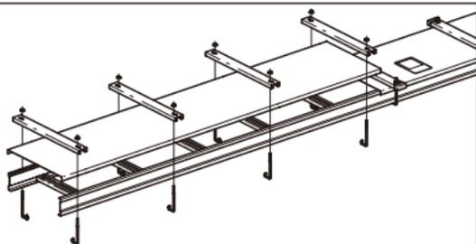
カバー 1枚に対してカバークランプを4箇所以上取り付けてください。(カバーの継ぎ目に取り付けるものは数量に含みません。)飛散・落下の恐れがあります。
