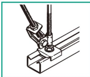
ご注意：振れ止め金具の取付位置は、吊りボルトを支持部接合点付近に取付けて下さい。
